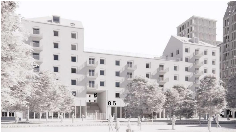
Figur 40 Illustration på hur man kan utforma portiker i markplan för att släppa ut skyfallsvatten från en upphöjd gård. Bild: White Arkitekter (2025-01-22).
