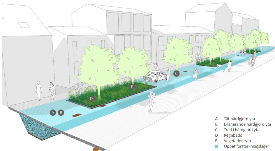
Figur 41 Exempel på gaturum med BGG-system förlagd i flexzon. Det blå området symboliserar ett öppet förstärkningslager som här ligger i ett stråk utmed hela gatan. På markytan varvas hårdgjorda ytor med regnbäddar, vegetationsytor och träd på valfritt sätt. På detta sätt ges stora möjligheter till hantering av dagvatten samtidigt som gaturummet kan utformas flexibelt. (Källa: Levande stadsrum – en handbok i Blågröngrå system, Edge 2024).
